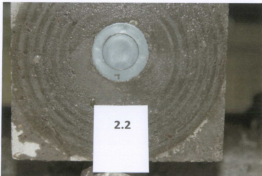
Foto 2: FSK Fertigspreize 2.2 mit Sperrstopfen nach der Prüfung
